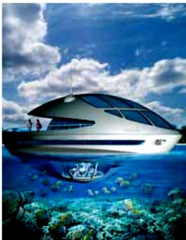
confronti dell'ambiente, sono quindi ecocompatibili. Attraverso materiali, tecnologie e soluzioni formali è possibile creare architetture innovative e "friendly environment". Il Trilobis è riciclabile per ben l'80 per cento, i pannelli fotovoltaici gli permettono di ottenere l'energia di cui necessita e i motori a celle a combustibile di idrogeno funzionano immerdando in mare
