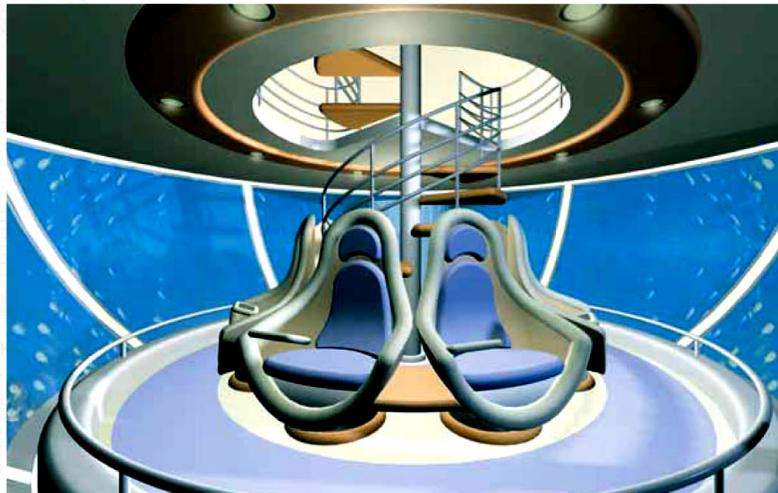
Sopra a destra, la bolla per l'osservazione che si trova a 3 metri sotto il livello del mare. Da qui la vetrata consente una visibilità dei fondali a 360 gradi grazie anche all'illuminazione data dalle luci esterne. I pannelli fotovoltaici federati sulla cupola permettono di trasformare l'energia in elettricità per il Trilobis 65.
